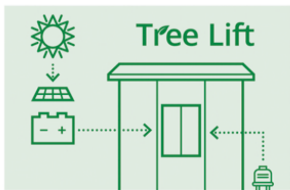
Funzionamento del sistema Tree Lift: l'ascensore viene alimentato dalla rete elettrica e da energia fotovoltaica, garantendo risparmio, sostenibilità e sicurezza in caso di blackout.
